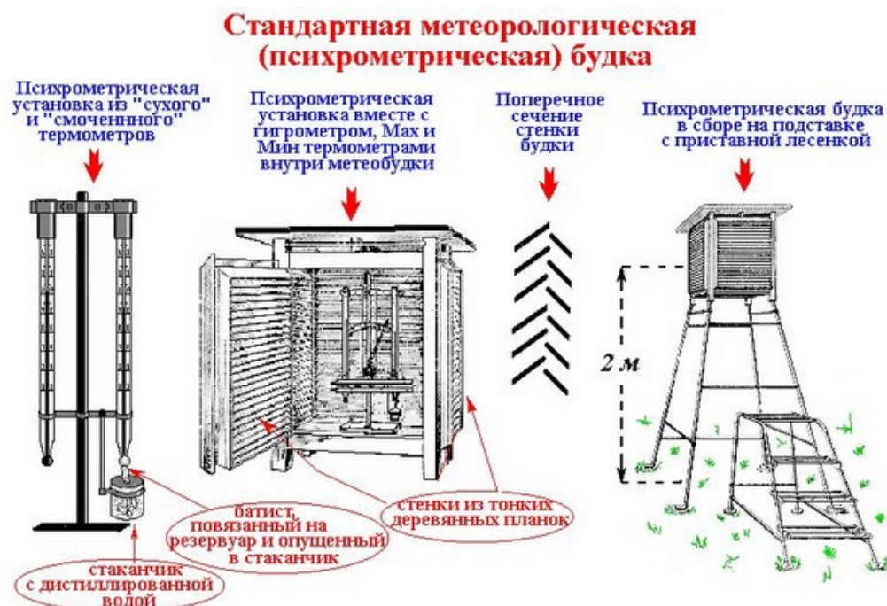
Рис. 3. Психрометрическая будка (общий вид)
